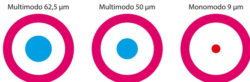
El coste de fabricación de una fibra monomodo es superior por el emisor de luz que se utiliza. Son diodos láser con mayor potencia y direccionalidad que el diodo tipo LED que utiliza la fibra multimodo, que genera una luz más difusa.
