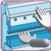
Pinchazo, perforación, cizallamiento, amputación, corte
